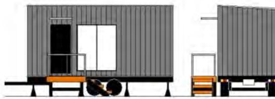
＜構造＞木造2×4工法 断熱/グラスウール、スチレンフォーム、屋根・外装/ガルバリウム鋼板、シャーシ付き
