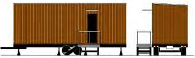
＜構造＞木造2×4工法 断熱/グラスウール、スチレンフォーム、屋根・外装/ガルバリウム鋼板、シャーシ付き
