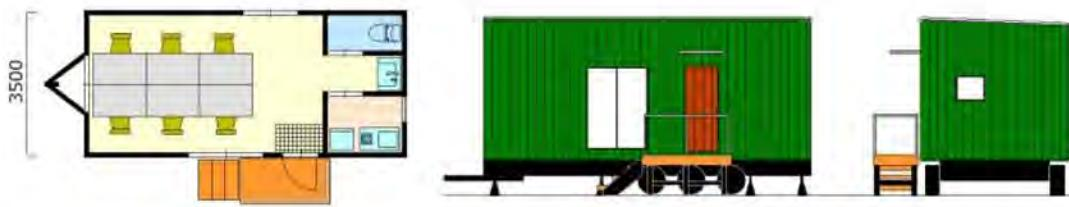
＜構造＞木造在来工法 断熱/グラスウール、スチレンフォーム、屋根・外装/ガルバリウム鋼板、シャーシ付き
