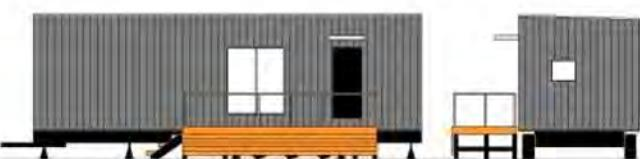
＜構造＞木造在来工法 断熱/グラスウール、スチレンフォーム、屋根・外装/ガルバリウム鋼板、シャーシ付き
