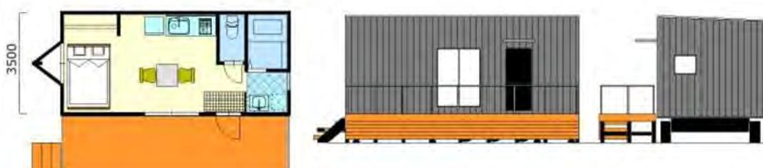
＜構造＞木造在来工法 断熱/グラスウール、スチレンフォーム、屋根・外装/ガルバリウム鋼板、シャーシ付き
