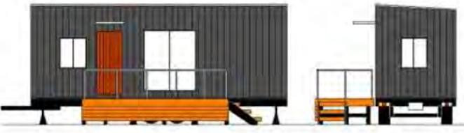
＜構造＞木造2×4工法 断熱/グラスウール、スチレンフォーム、屋根・外装/ガルバリウム鋼板、シャーシ付き
