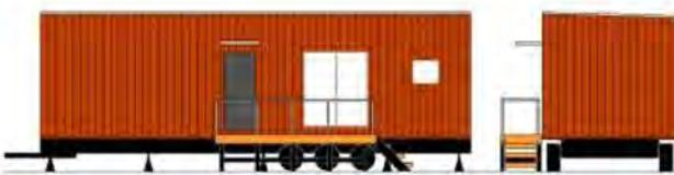
＜構造＞木造在来工法 断熱/グラスウール、スチレンフォーム、屋根・外装/ガルバリウム鋼板、シャーシ付き
